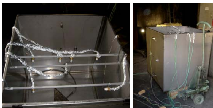
Deney kabındaki sensor konumu.
